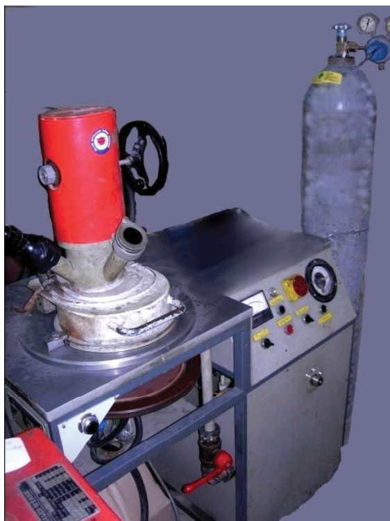
Рисунок 11. Электродуговая вакуумная печь ЛК-8
