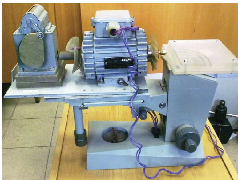
Рисунок 17. Установка для усталостных испытаний тонких проволок
